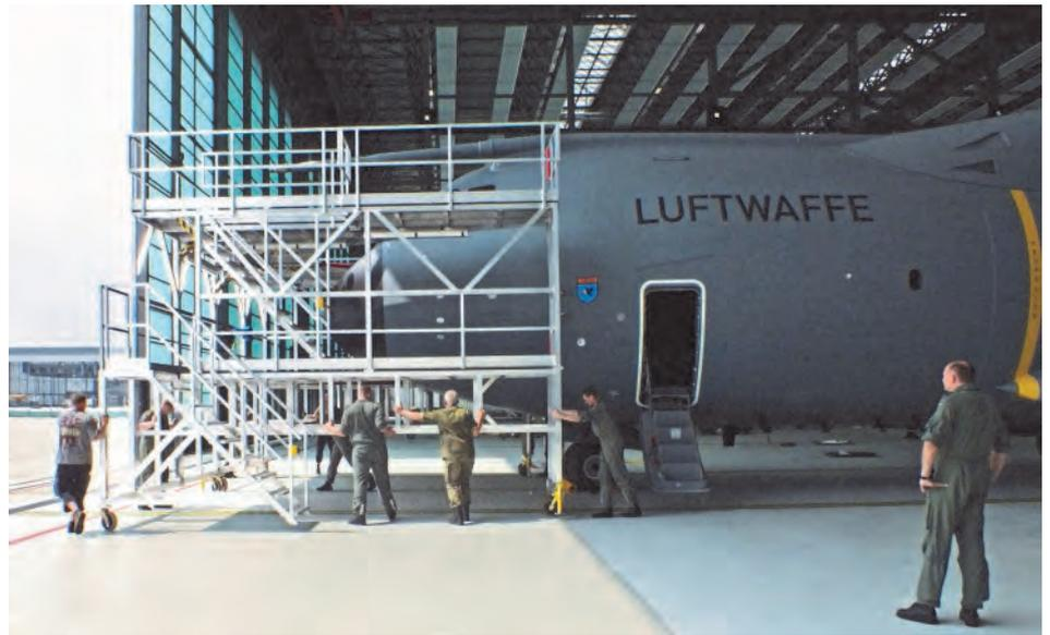
Mit dem Nosedock wird das Arbeiten am vorderen Bereich des Flugzeugs sichergestellt. Über die zwei Wingdocks und die Upper-Fuselage-Docks erreicht man die Tragflächen und das Leitwerk.
