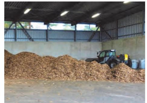
Die Sägewerkshackschnitzel aus Waldrestholz oder naturbelassenem Holz werden als Brennstoff für die Wärmeerzeugung in einem Hochleistungskessel verwendet.
