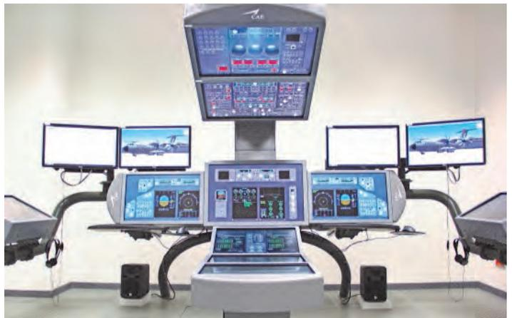
**Die Ausbildung von Bedienung im Cockpit und das Vermitteln von Systemdiagnosefähigkeit erfolgt am Touch Panel Cockpit.**
