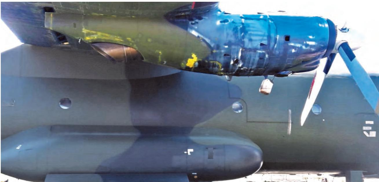
Am abgebeizten Triebwerk und dem neu lackierten Rumpf ist der Zustand Vorher/Nachher besonders gut zu erkennen.
