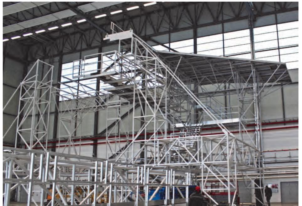
docks zusammengebaut. Diese sind fahrbar und können in der Höhe verstellt werden. Nach deren Fertigstellung wurden diese an die Triebwerke des Flugzeuges gefahren, um die Funktion zu überprüfen. Danach wurde das Nosedock montiert und ebenfalls am Luftfahrzeug getestet. Als drittes wurden die ca. 13 Meter hohen Heckdocks zusammengebaut. Das Heckdock besteht aus zwei über eine Kurbel seitlich zu bewegende Hälften. Auf dem Hallenboden wurden mehrere Schienen befestigt.
