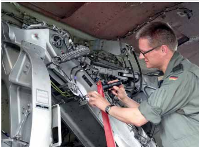
Im Fahrwerksschacht werden alle Steckverbindungen überprüft und auf die richtige „Biegung“ der Hydraulikleitungen geachtet.
