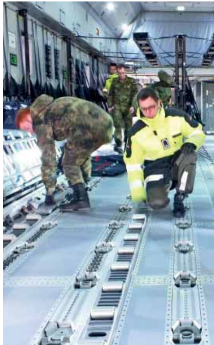
Einbau von der Rollen und des Schienensystems (li.) und der Mittelsitze.
