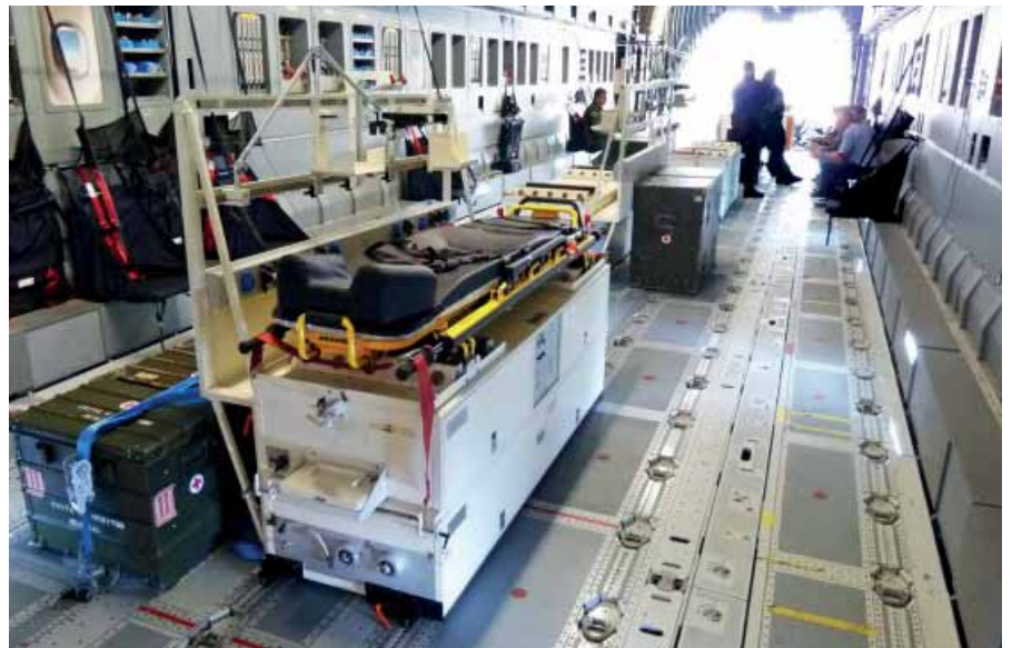
Noch wird die MEDEVAC-Ausstattung einzeln verzurrt. Später ist sie auf Paletten fertig zum Einschub montiert.
