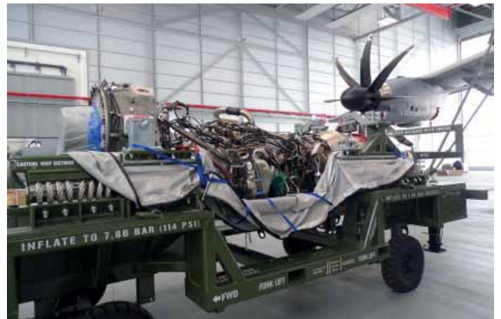
Die Techniker sind froh, dass sie, wie hier beim Triebwerkswechsel, gute Arbeitsbedingungen haben.
