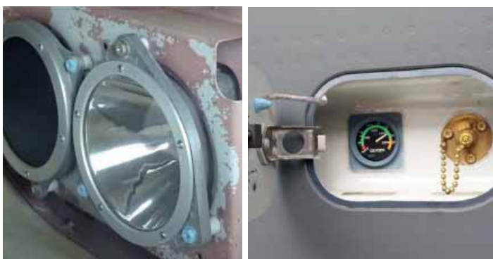
Penibel wird darauf geachtet, dass die Landescheinwerfer sauber sind oder die Abdeckung für die Anzeige der Sauerstoffanlage gängig und keine Feuchtigkeit in der Anzeige ist.
