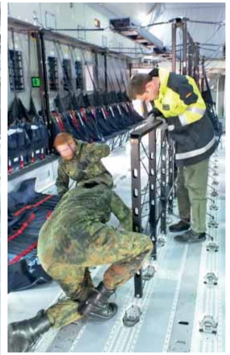
Einbau von der Rollen und des Schienensystems (li.) und der Mittelsitze.
