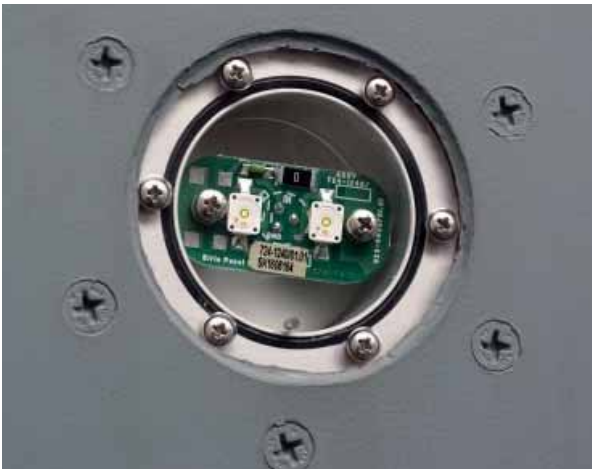
Das Abdeckglas der äußere Notbeleuchtung (li.) muss unbeschädigt und klar sein.
