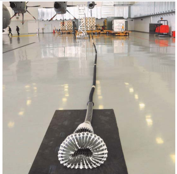
Im Flug wird der Schlauch durch den Luftwiderstand straff gezogen. Der Korb hat einen Durchmesser von nur 75 cm.
