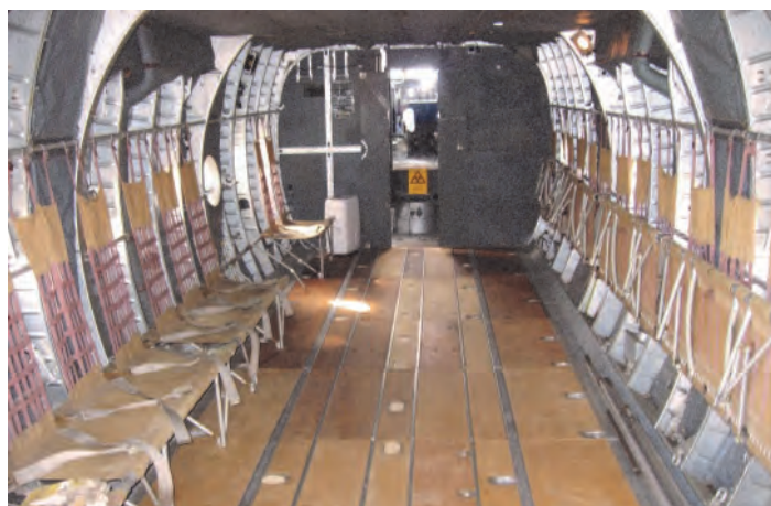
Jetziger Zustand. Gereinigt und Instandgesetzt. Es fehlen noch die Teppiche und der Bildschirm der rechts an der Trennwand installiert wird.
