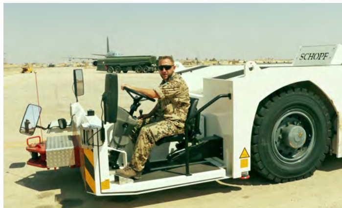
Das Schleppfahrzeug hat auch hinten einen Fahrstand.
