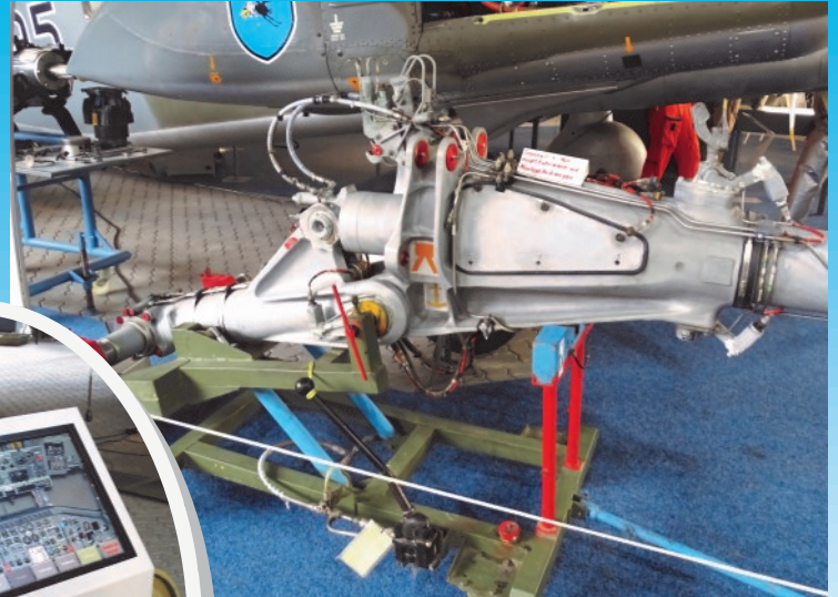
Hauptfahrwerk der C 160 Transall mit Transportschlitten.
