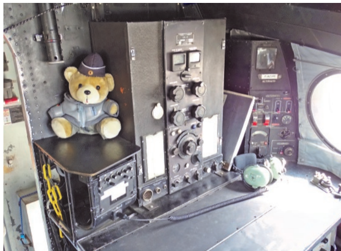
Der Arbeitsplatz des Bordfunkers, der häufig über Langwelle und per Morsetechnik den Kontakt zur Flugsicherung hielt.
