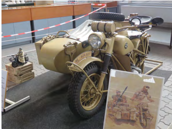
Das Motorrad mit Beiwagen wurde als Verbindungsfahrzeug genutzt und konnte zwischen dem Fahrwerk der JU als Außenlast transportiert werden.
