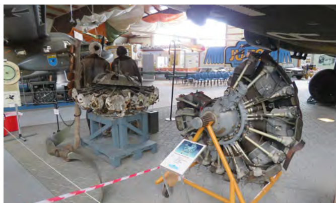
Das Triebwerksschnittmodell ist der russische Nachbau des BMW-Motors für die Antonow AN-2
