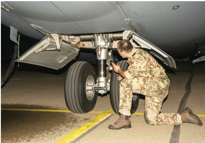
Vor und nach dem Flug wird das Fahrwerk des A400M untersucht.
