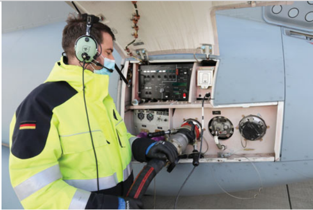
Das Be- und Enttanken erfolgt beim A400M über eine Steuereinheit, die sich zwischen Fahrwerk und der Springertür befindet.
