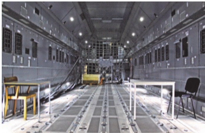
Der „Cargo-Hold-Trainer-Enhanced“ ist eine 1:1 Nachbildung des wahren Laderaums mit allen Be- und Entladungsmöglichkeiten. Auch die Kommunikation mit dem Flight Simulator ermöglicht das Crewtraining.
