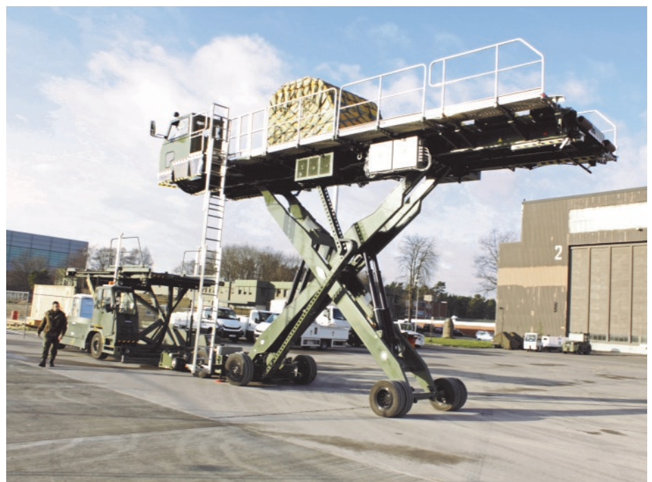
Der direkte Vergleich alt gegen neu: Mulag LT 10 (hinten) gegen PFA 50 für den A400M (vorn).
