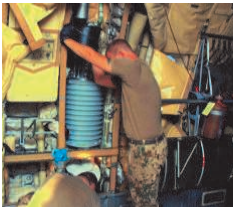
Hauptfeldwebel Oliver B. und Stabsunteroffizier Hans-Christian S. beim Ausbau des Hydraulikbehälters.
