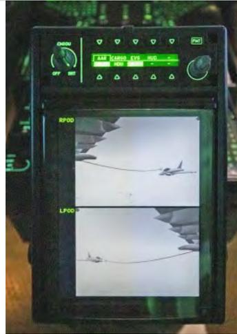
**Sogar die im A400M vorhandenen Außenkameras werden in die Simulation integriert. Für die Luftbetankung sehr wichtig.**
