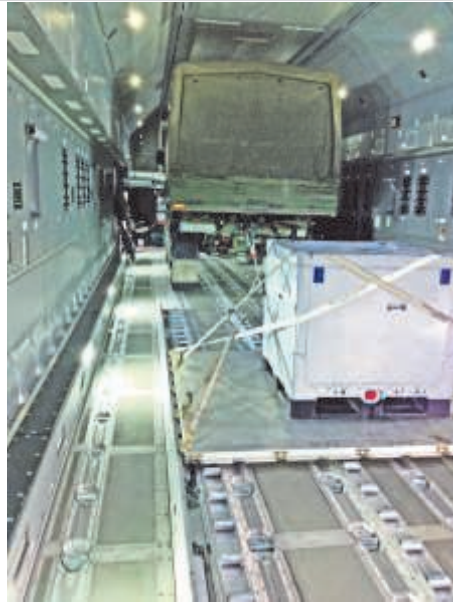
Eine Beladeübung im CHT-E. Sie zeigt die Leistungsfähigkeit des A400M: Einen LKW plus Palettentransport. Zusätzlich können hier noch 54 Personen mit transportiert werden.
