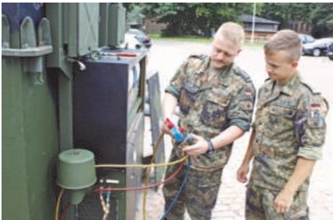
SU Tino Kania, Klimamechatroniker (li.), und HG Noco Puetz beim Überprüfen einer Kabinenklimaanlage.
